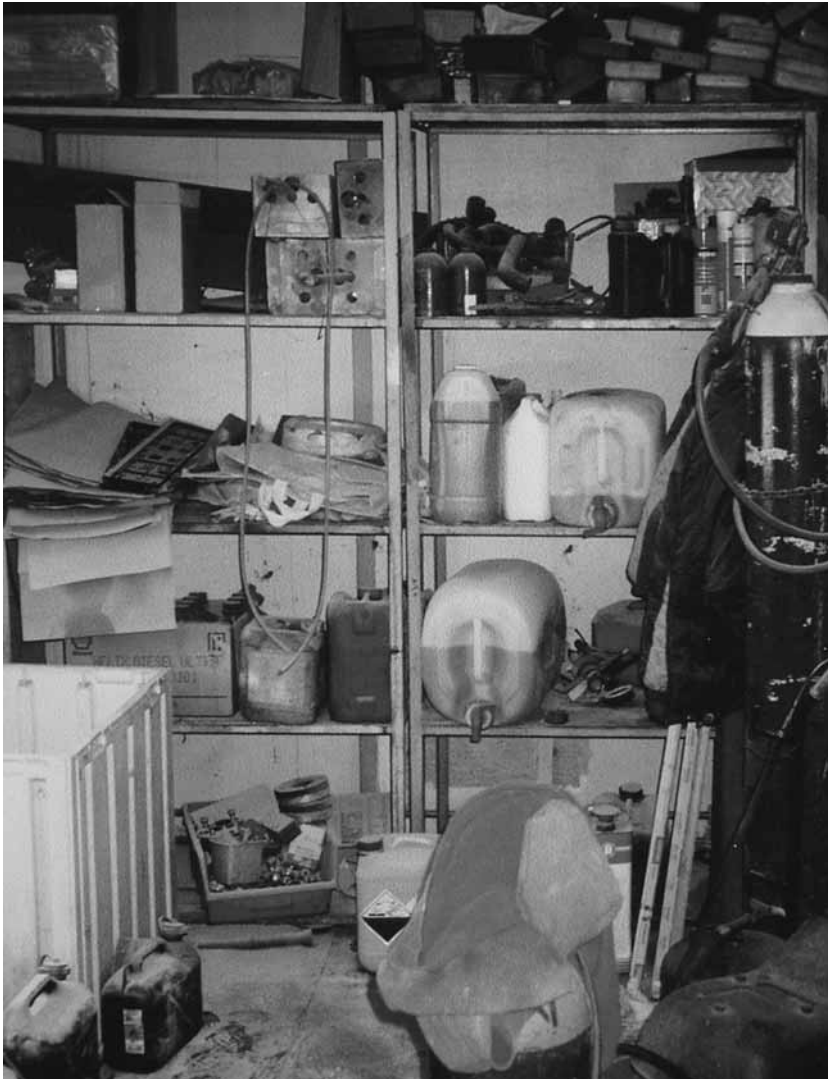
Lagern von Gefahrstoffen mit unzureichenden Schutzmaßnahmen
